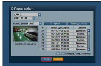
6. Можно изменить скорость воспроизведения или канал, или же остановить воспроизведение с помощью экранной панели кнопок.
