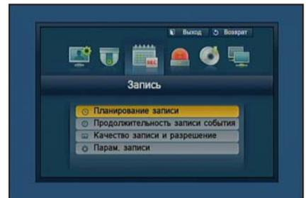
2. Для каждой записи установите параметры планирования записи. Чтобы изменить настройку, установите канал, затем выберите время и дату, когда вы хотите выполнить запись. Нажмите кнопку [ENTER] по мере выбора ячейки. Тип записи будет идти циклически <Нет записи>-<Непрерывно>-<Событие>-<Обе (неп. и соб.)>. Значения по умолчанию показано ниже.
